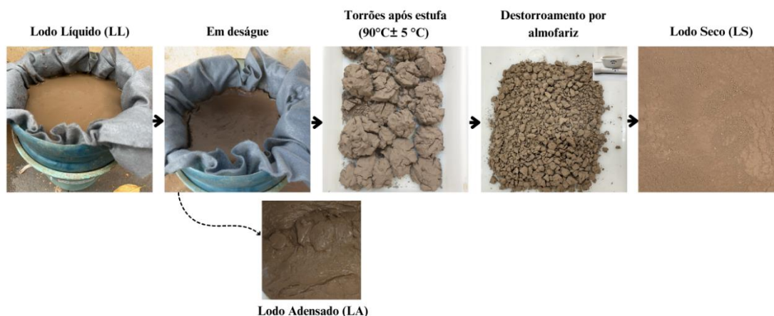
Figura 1 - Ensaio para a obtenção do LETA em diferentes estados físicos
